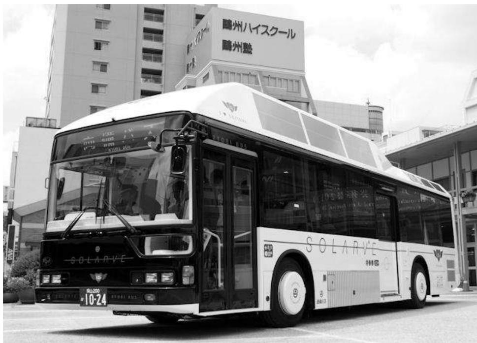
話ですが岡山には今、世界で一番地球に優しいハイブリッド路線バスが走っているのを皆様にご存知でしょうか。その名は「SOLARVE（ソラビ）」号。白を基調とした車体で屋根には大きなソーラーパネルを搭載されている目立つバスなので、街中で見かけた方も多いのではないのでしょうか。実はこのハイブリッド路線バス、屋根に搭載されたソーラーパネルで作られた電気を室内灯（しかもLED）に使用しているのです。世界初の試みで環境に配慮された、晴れの国ならではの自慢の路線バスです。車内も白で統一され、ユニバーサルデザインを施した内装となっており、窓には紫外線（UV）カットフィルムを使用し、女性にも優しいバスとなっています。”現在岡山駅～西大寺（東区）間1日4往復を中心に運行されていますので是非ご乗車してみてください。”
